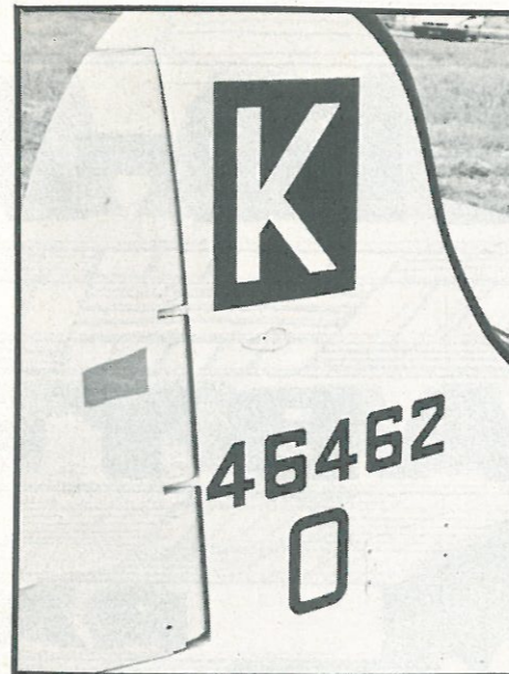
Détail de la dérive du B 17. Remarquez les pièces rivées et l'entoilage de la surface mobile.
