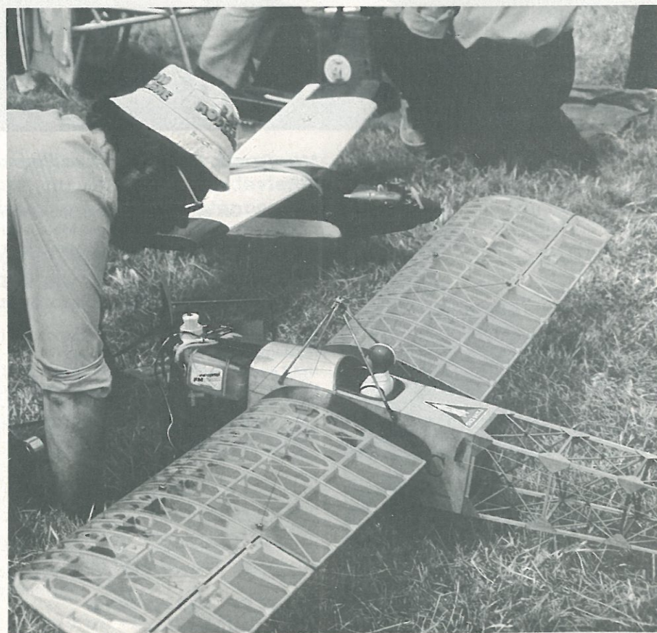
Un bel exercice de style, non ? Les nervures en structure ajourée et le fuselage en dentelle.
