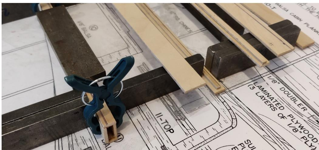
Pour le moment, la semelle supérieure est juste positionnée en attente de mise en place des différentes fixations avant (sur la partie centrale de l'aile), arrière (sur l'empennage), renforts pour les multiples haubans et passage des câbles de servos. Plus facile de trifouiller à l'intérieur avec le capot ouvert. On y verra plus clair une fois la partie centrale de l'aile faite. A ce moment on pourra ajuster tout ça et fermer/coller l'ensemble.
