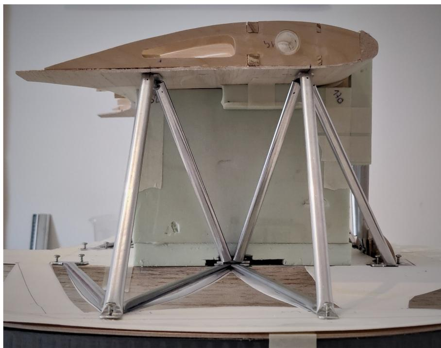
C'est symétrique, et parfaitement conforme au gabarit de positionnement du tronçon central de l'aile (angle d'incidence  $2,2^\circ$ ).
