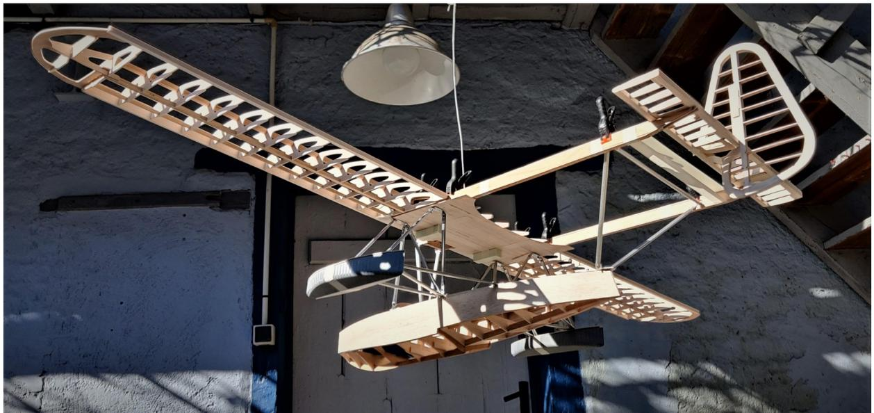
Avant la mise en place définitive des différents composants, j'ai eu un échange avec Franck A. (que je remercie une fois encore pour son aide) pour me conforter et sur la position du CG et sur la valeur des angles d'incidence de l'aile et de l'empennage pour cette architecture quand même un peu atypique. Et avec l'accus 5S4000mah dans la soute avant, ça va le faire sans ajout de charge inutile.
