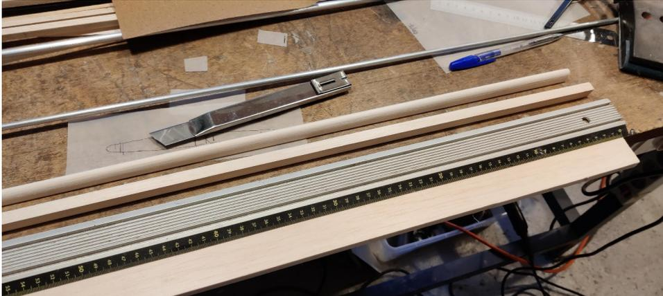
Puis découpe des nervures dans du balsa ep 2mm
