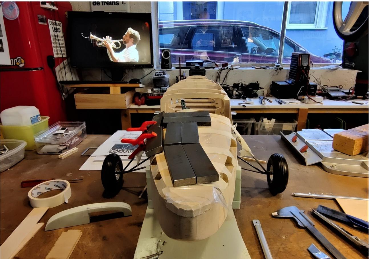
Capot avant terminé, la future trappe à accus (trappe qui sera stratifié sur la forme), et les tentatives de pare brise avant (qui restera démontable pour accéder au servo de la roulette AR)
