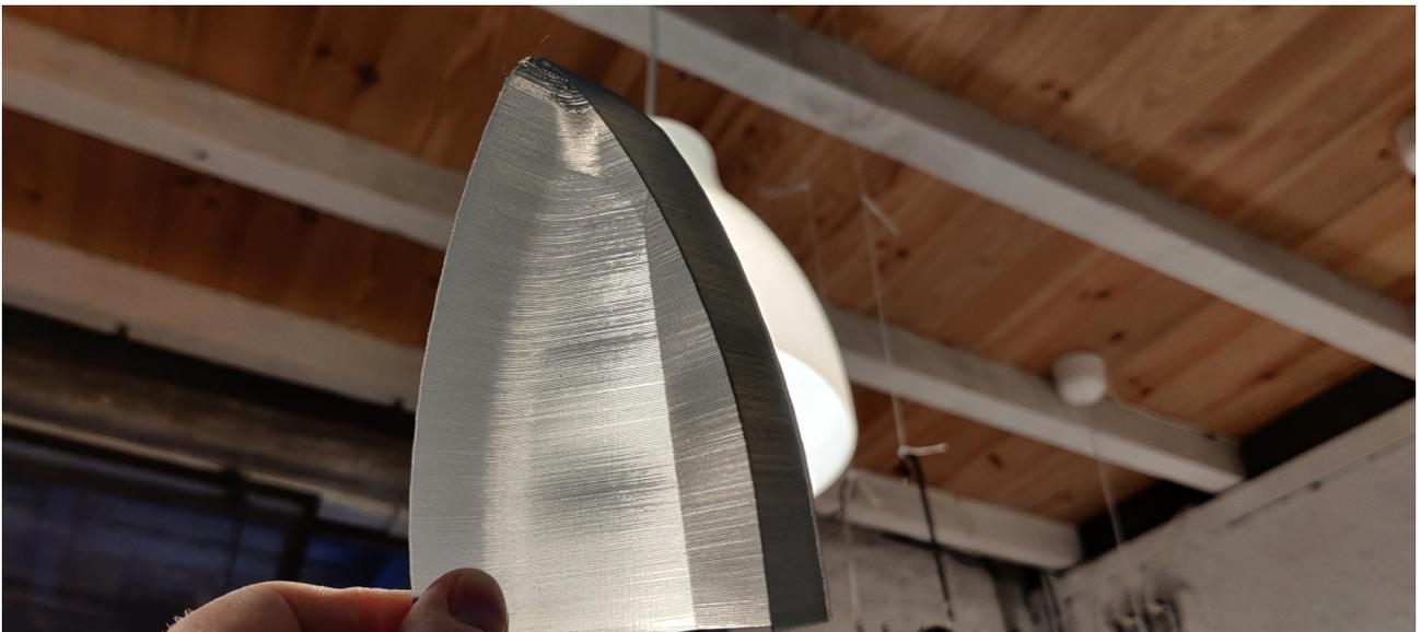
Solution retenue : 2 couches, remplissage 1% avec plaque supérieur en CP. Il ne reste plus qu'à mettre les écrous en place, collée, apprêter, poncer et peindre...Quand il fera plus chaud !
