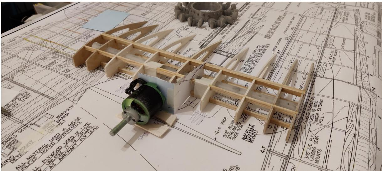
Réalisation de la boîte support moteur et mise en place
