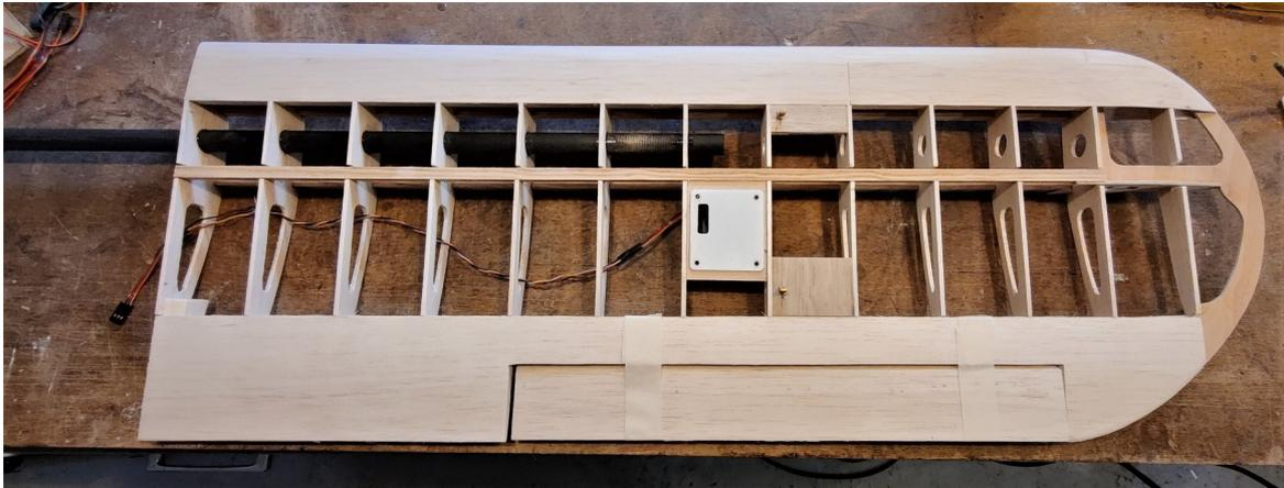
L'empennage avec les 2 servos de profondeur + le 1 servos de dérive
