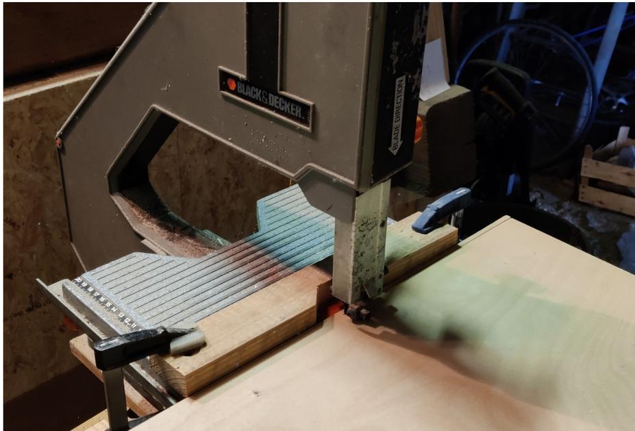
Et comme les planches font 600mm et la poutre 700mm, on passe forcément par un assemblage en sifflet...
